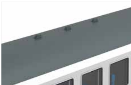
Separat angesetzte WLAN-Antennen
