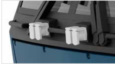
Filigrane extra angesetzte Griffstangen, UIC-Dosen und Scheibenwischer
