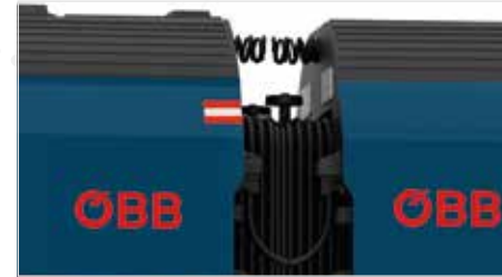
Nachbildung aller Übergangsleitungen zwischen den Wagen
